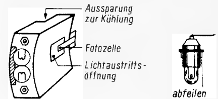
Bild 1. Die Anordnung der beiden Glühlämpchen
