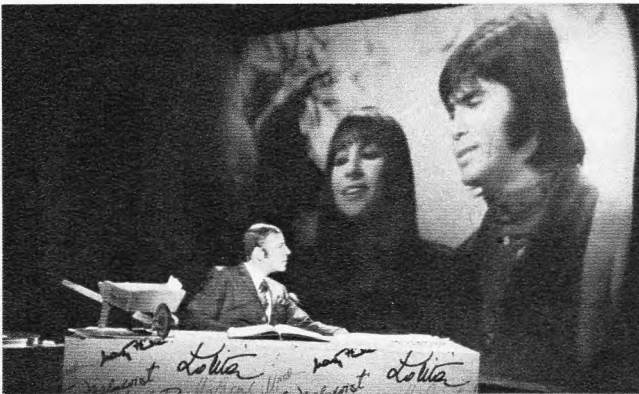
Oben: Bild 1. Back-ground-Farbbildprojektion mit dem Simultan-Eidophor-Projektor bei der letzten Sendung „Musik aus Studio B“. Chris Howland im Vordergrund mußte hell angestrahlt werden, um ein gutes Bild mit der Studio-Farbkamera zu erzielen, dagegen durfte die Projektionswand nicht zu stark aufgeleuchtet werden, um Kontrastverluste zu vermeiden (Aufnahme: NDR)
