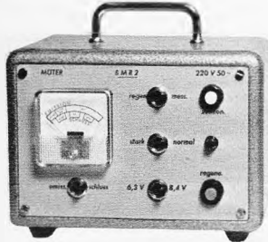
Bildröhren-Meß-Regenerator BMR 2 für Werkstatt und Altrgeräte-Abteilung
